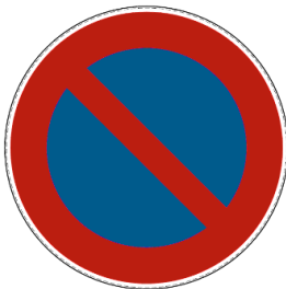
Signal E1 stationnement interdit, mais arrêt autorisé
